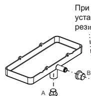
При вертикальной установке вытащить резиновую пробку А
