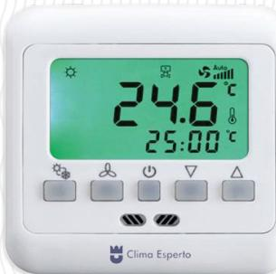
Термостат серии CETP представляет собой микропроцессорный контроллер с жидкокристаллическим дисплеем. Термостат предназначен для контроля температуры воздуха в помещении путем управления вентилятором и клапанами с электроприводом в системах охлаждения и обогрева воздуха. 3 скорости вентилятора могут быть установлены в автоматическом или ручном режиме.
